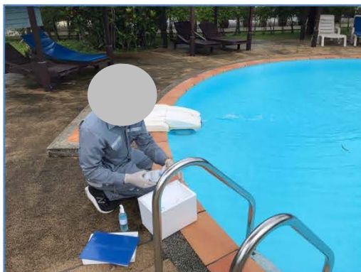
ภาพถ่ายที่ 3.4.13-1 การตรวจวัดคุณภาพน้ำจากสระว่ายน้ำ
